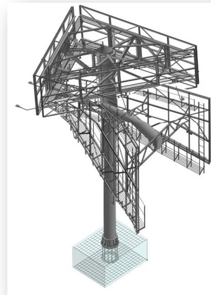
2.14. **Пилоны (стелы)** - отдельно стоящие, высокие, вытянутые в вертикальной плоскости рекламные конструкции с внутренней подвеской, одним или двумя рекламными полями, устанавливаемые в непосредственной близости к объекту рекламы;
