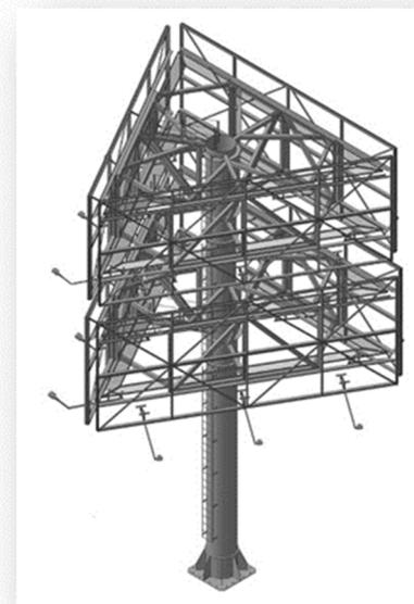
2.13. **Щит (билборд) пятисторонний** - щитовые рекламные конструкции среднего формата, имеющие внешние поверхности, специально предназначенные для размещения рекламы. Щиты состоят из фундамента, каркаса, опоры и информационных полей в количестве 5 штук. Площадь информационных полей щита определяется общей площадью его сторон. Обычно используются вблизи торговых центров, гипермаркетов или строительных магазинов;
