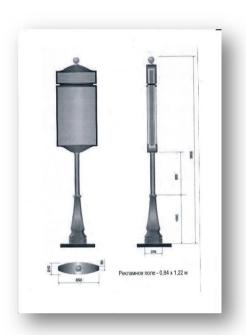
2.6. *Тумбы* - рекламные конструкции малого формата с внутренним подсветом, имеющие три или четыре внешние поверхности с информационными полями размером не более 1,4 х 3 м для размещения рекламы. При установке тумб общая высота конструкции не должна превышать 4,7 м.
