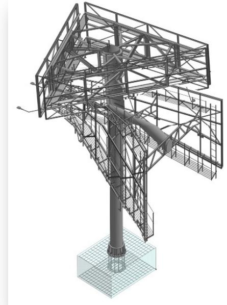
**2.15. Пилоны (стелы)** - отдельно стоящие, высокие, вытянутые в вертикальной плоскости рекламные конструкции с внутренней подвеской, одним или двумя рекламными полями, устанавливаемые в непосредственной близости к объекту рекламы;
