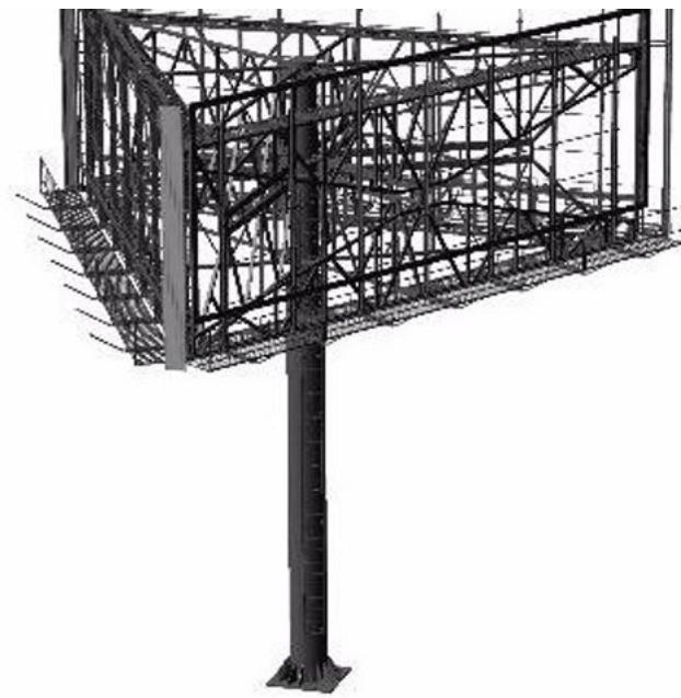
2.13. **Билборд (щит)** **шестисторонний** - щитовые рекламные конструкции среднего формата, имеющие внешние поверхности, специально предназначенные для размещения рекламы. Щиты состоят из фундамента, каркаса, опоры и информационных полей в количестве 6 штук. Площадь информационных полей щита определяется общей площадью его сторон. Обычно используются вблизи торговых центров;
