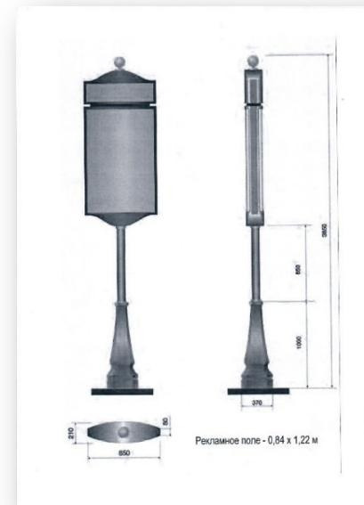
**2.6. Тумбы** - рекламные конструкции малого формата с внутренним подсветом, имеющие три или четыре внешние поверхности с информационными полями размером не более 1,4 x 3 м для размещения рекламы. При установке тумб общая высота конструкции не должна превышать 4,7 м.
