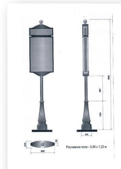
2.7. **Тумбы** - рекламные конструкции малого формата с внутренним подсветом, имеющие три или четыре внешние поверхности с информационными полями размером не более 1,4 х 3 м для размещения рекламы. При установке тумб общая высота конструкции не должна превышать 4,7 м.
