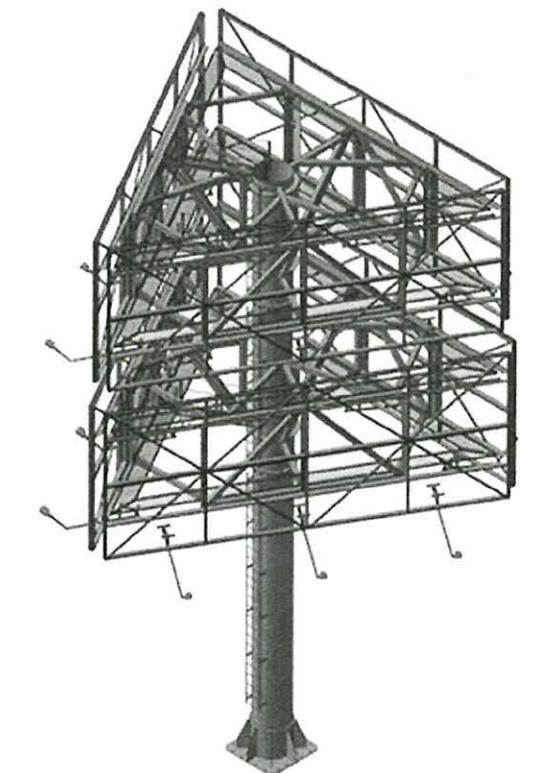
2.14. **Щит (билборд) пятисторонний** - щитовые рекламные конструкции среднего формата, имеющие внешние поверхности, специально предназначенные для размещения рекламы. Щиты состоят из фундамента, каркаса, опоры и информационных полей в количестве 5 штук. Площадь информационных полей щита определяется общей площадью его сторон. Обычно используются вблизи торговых центров, гипермаркетов или строительных магазинов;
