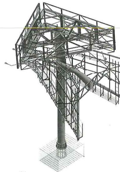
2.15. **Пилоны (стелы)** - отдельно стоящие, высокие, вытянутые в вертикальной плоскости рекламные конструкции с внутренней подвеской, одним или двумя рекламными полями, устанавливаемые в непосредственной близости к объекту рекламы;
