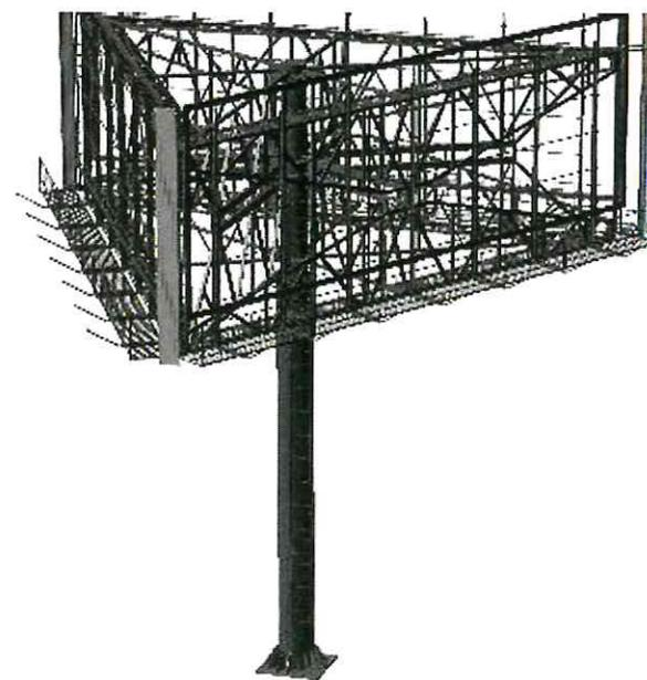
2.13. **Билборд (щит) шестисторонний** - щитовые рекламные конструкции среднего формата, имеющие внешние поверхности, специально предназначенные для размещения рекламы. Щиты состоят из фундамента, каркаса, опоры и информационных полей в количестве 6 штук. Площадь информационных полей щита определяется общей площадью его сторон. Обычно используются вблизи торговых центров;
