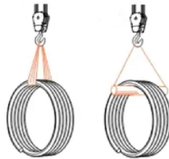
Схема строповки бухты с трубопроводом
