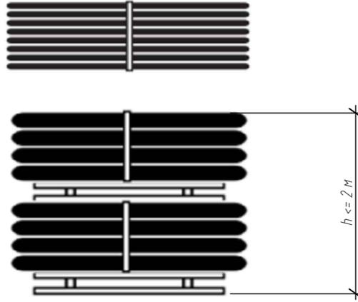
Схема складирования ж.б. плит
