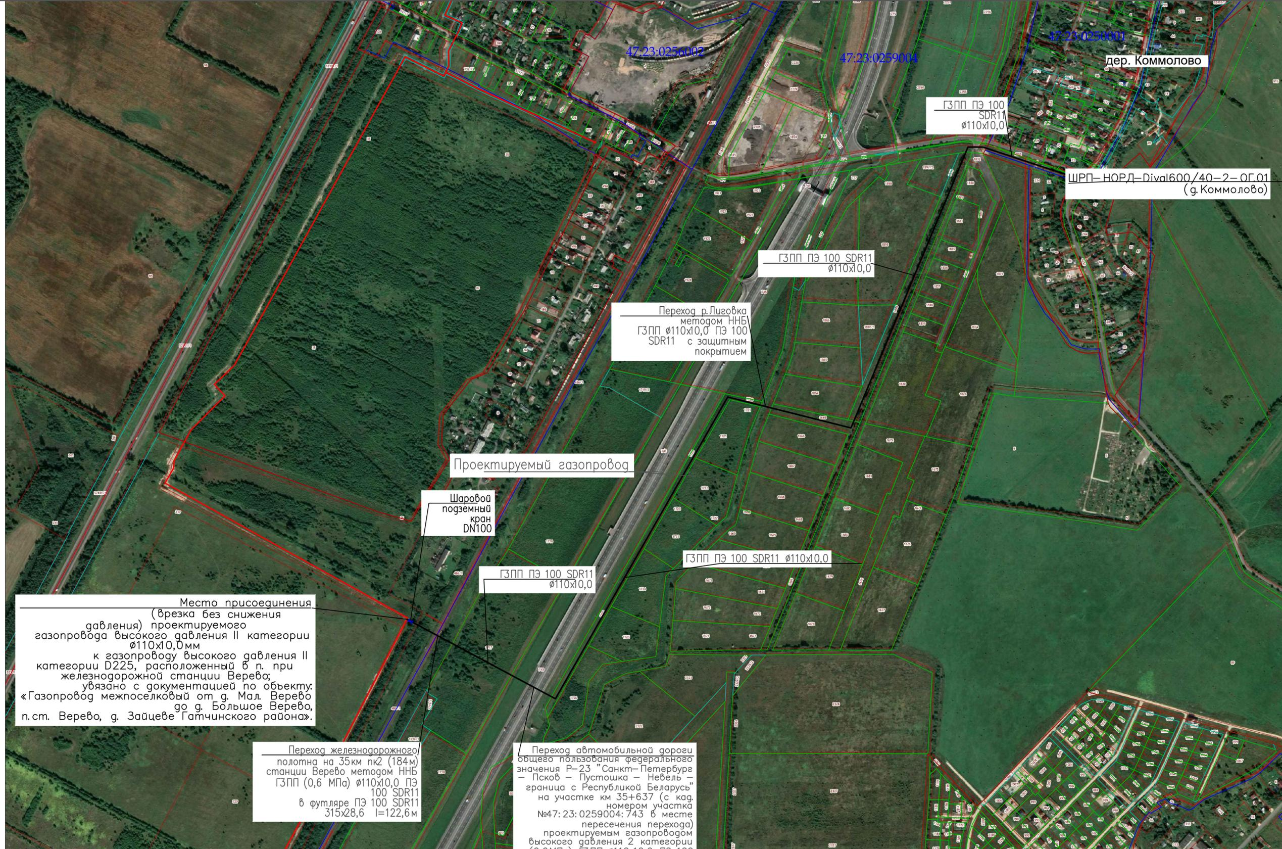
Место присоединения (врезка без снижения давления) проектируемого газопровода высокого давления II категории Ø110x10,0мм к газопроводу высокого давления II категории D225, расположенный в п. при железнодорожной станции Верево; увязано с документацией по объекту: «Газопровод межпоселковый от д. Мал. Верево до д. Большое Верево, п.ст. Верево, д. Зайцево Гатчинского района».
