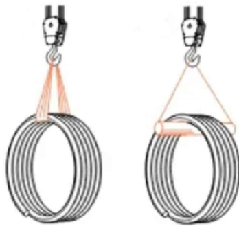
Схема строповки бухты с трубопроводом
