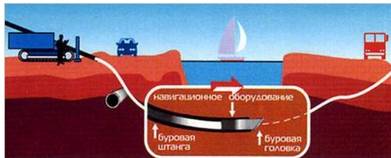
Рисунок 4. Бурение пилотной скважины (1 этап)
