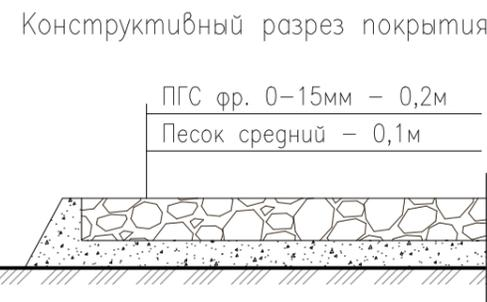
Конструктивный разрез покрытия
