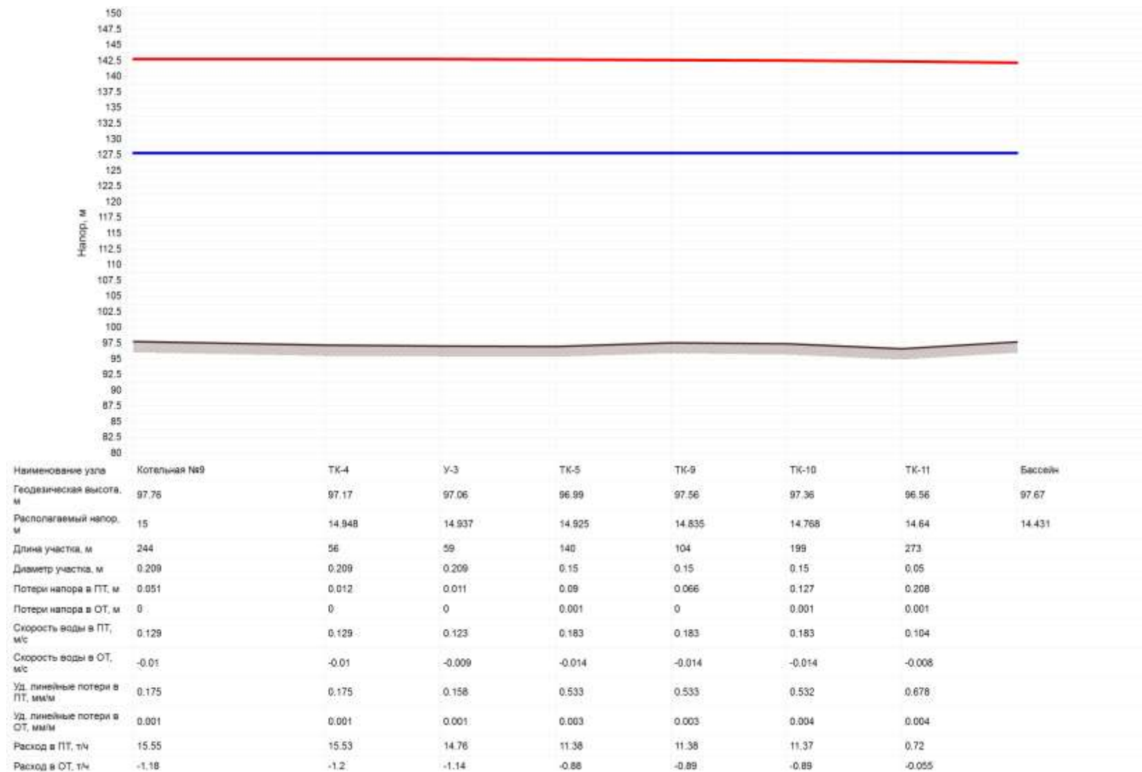
Рисунок 3.10.120 Пьезометрический график от котельной №9 дер. Большие Колпаны до Бассейна (перспектива) (ГВС)
