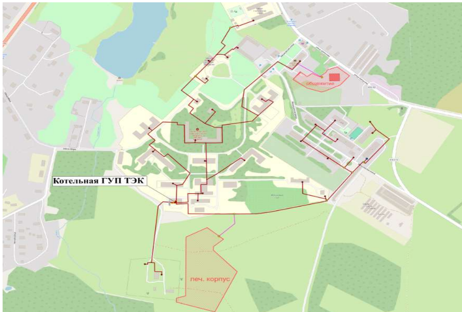
Рисунок 3.10.117 Схемы тепловых сетей котельной АО «ТЭК СПб», Ленинградская область, Гатчинский муниципальный район, Большеколпанское сельское поселение, массив Никольское, д. 1 на 2035 год (контур ГВС)
