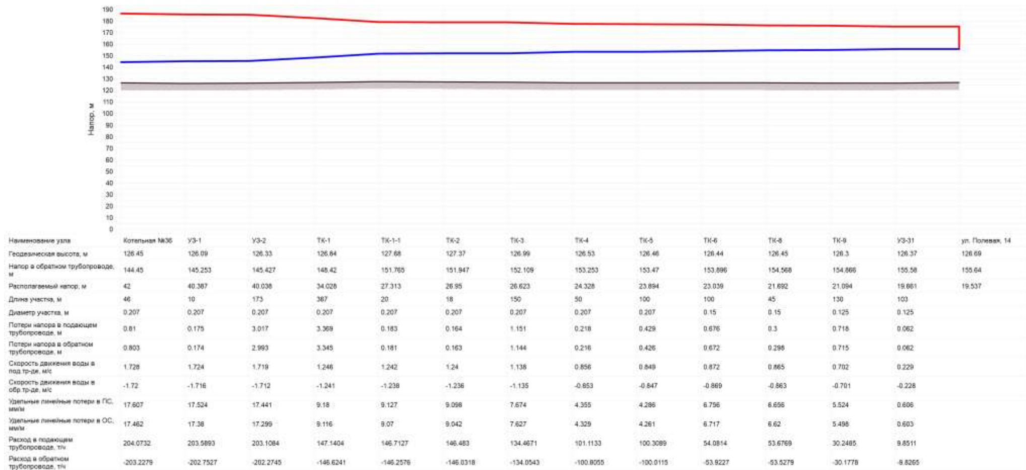
Рисунок 3.10.276 Пьезометрический график от котельной №36 до потребителя – ул. Полевая, 14 (контур отопления)
