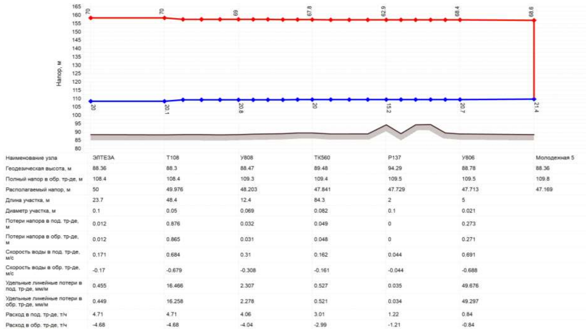
Рисунок 3.10.26 Существующий гидравлический режим тепловых сетей от котельной «ЭЛТЭЗА»
