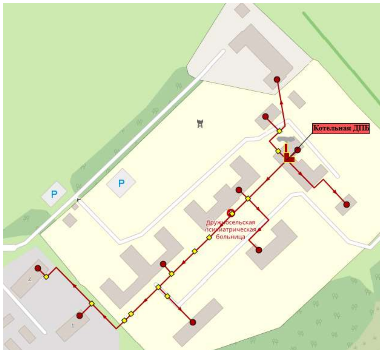
Рисунок 3.10.93 Схемы тепловых сетей котельной п. Дружноселье, ул. ДПБ, д. 3, стр. 5 (контур ГВС) на 2035 год
