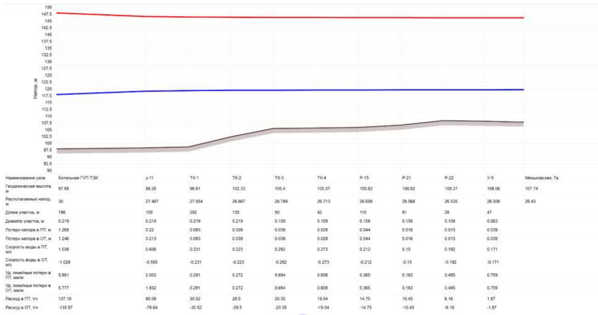
Рисунок 3.10.123 Пьезометрический график от котельной ГУП «ТЭК СПб» с. Никольское до Меньковская 7а (перспектива) (отопление)
