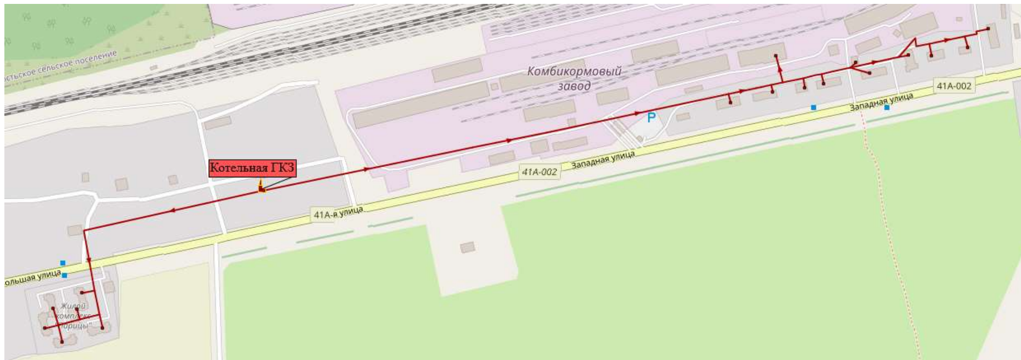
Рисунок 3.10.114 Схемы тепловых сетей котельной ГККЗ дер. Малые Колпаны на 2035 год (контур ГВС)
