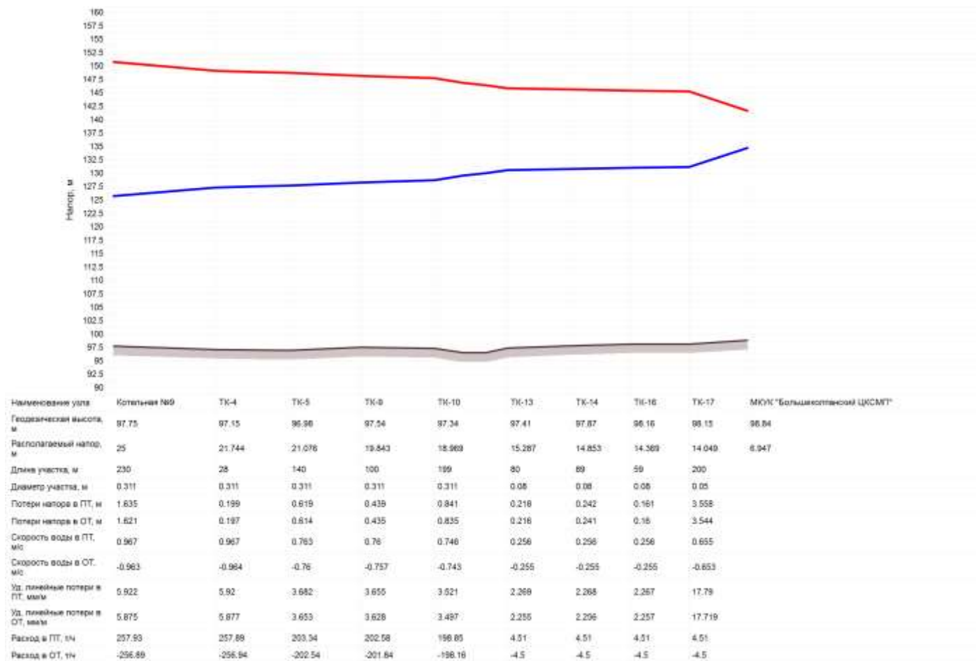
Рисунок 3.10.118 Пьезометрический график от котельной №9 дер. Большие Колпаны до МКУК Большеколпанский ЦКСМП (перспектива) (отопление)
