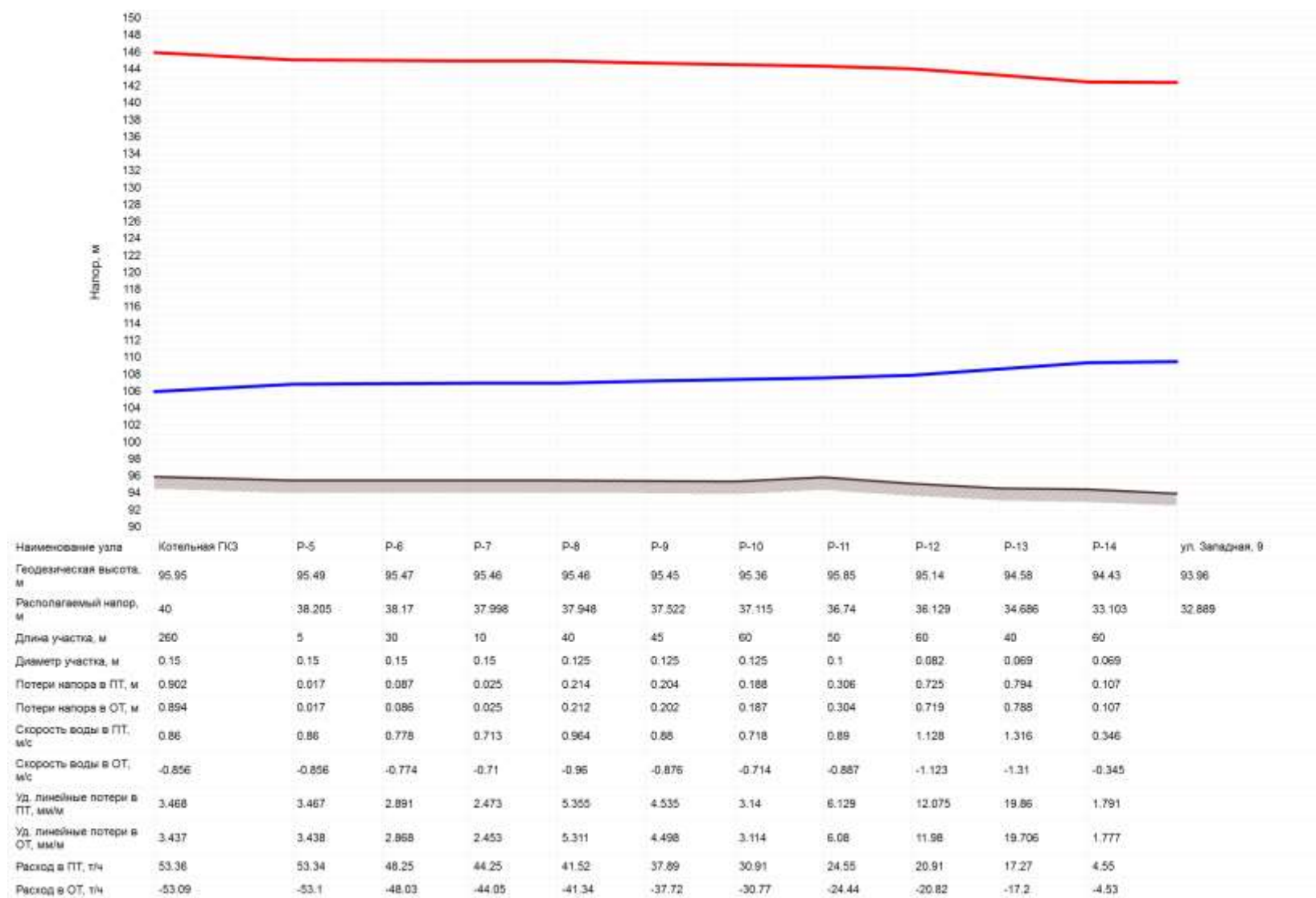
Рисунок 3.10.121 Пьезометрический график от котельной ГККЗ дер. Малые Колпаны до ул. Западная, д.9 (перспектива) (отопление)
