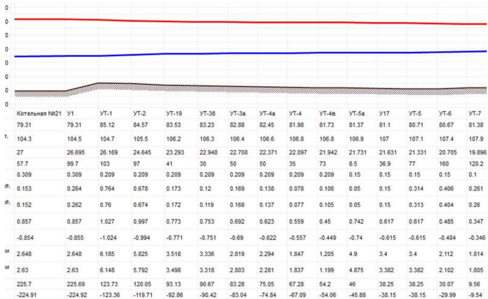
Рисунок 3.10.70 Пьезометрический график от котельной №21 до абонента по адресу ул. Введенского д. 7 (контур отопления)
