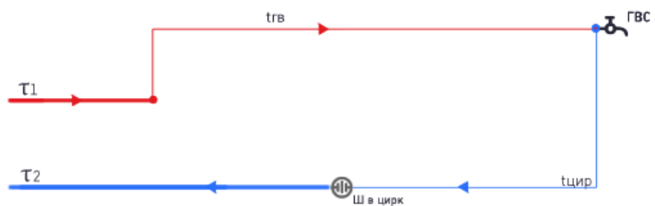
Рисунок 1.3.146 Схема с открытым водоразбором на ГВС
