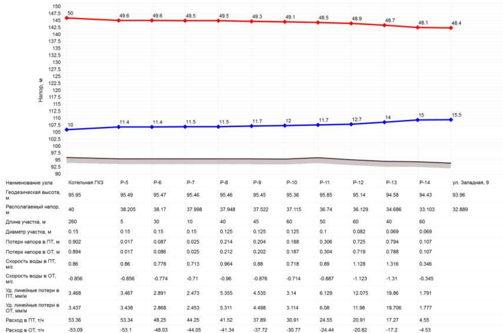
Рисунок 3.10.104 Пьезометрический график от котельной ГКЗ до ул. Западная д. 9 (отопление)
