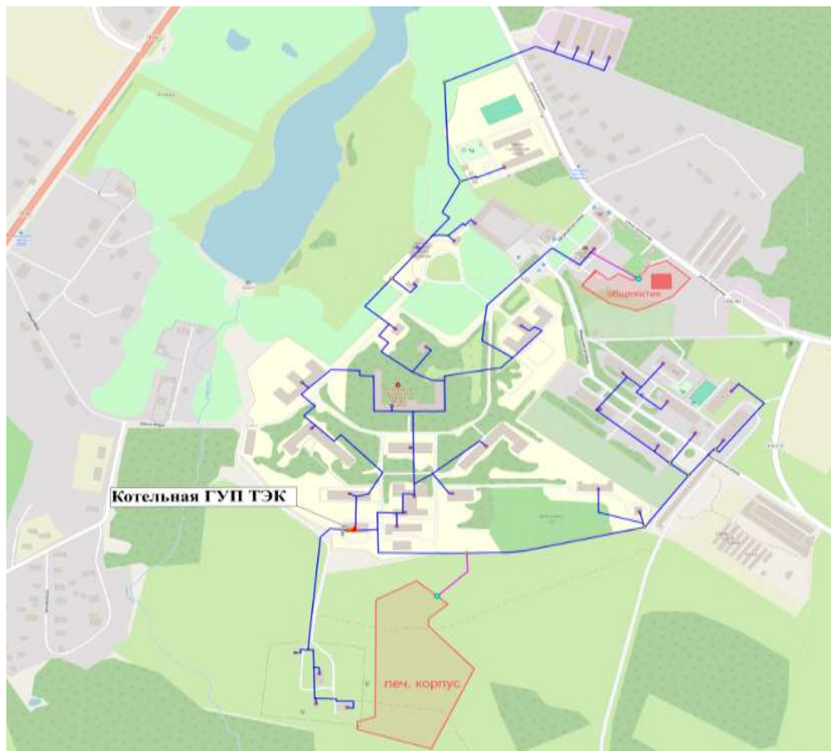
Рисунок 3.10.116 Схемы тепловых сетей котельной АО «ТЭК СПб», Ленинградская область, Гатчинский муниципальный район, Большеколпанское сельское поселение, массив Никольское, д. 1 на 2035 год (контур отопления)
