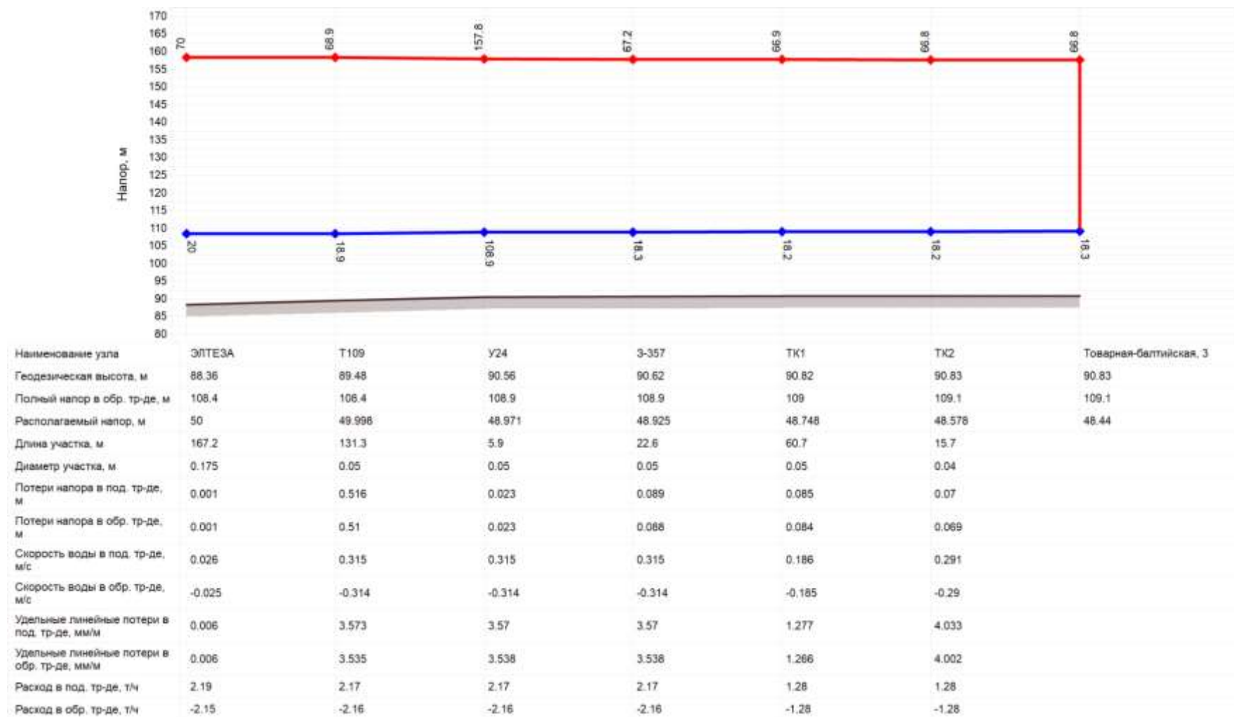
Рисунок 3.10.27 Существующий гидравлический режим тепловых сетей от котельной «ЭЛТЭЗА»
