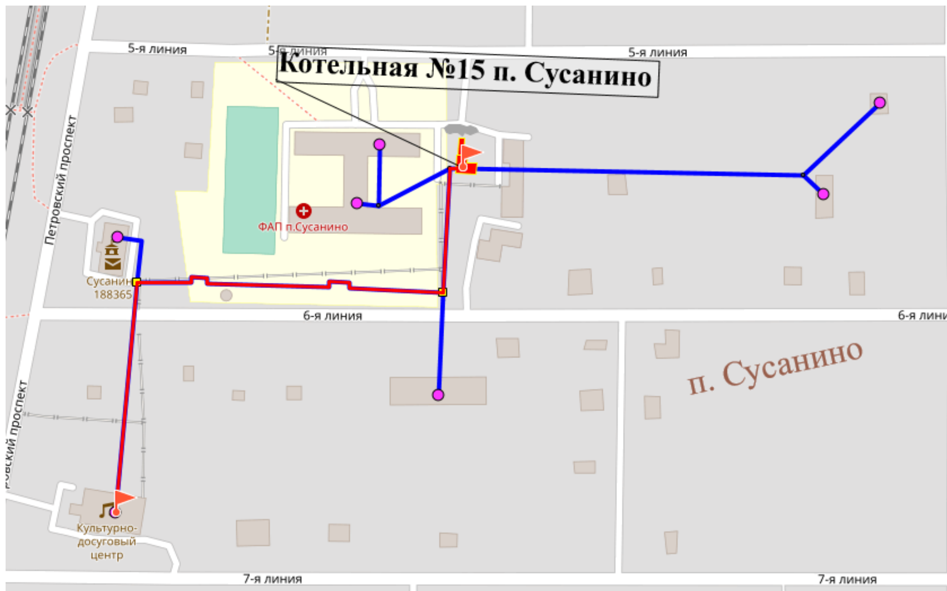
Рисунок 8. Путь построения пьезометрического графика от котельной №15 до потребителя МУК «Сусанинский КДЦ» (ДК)
