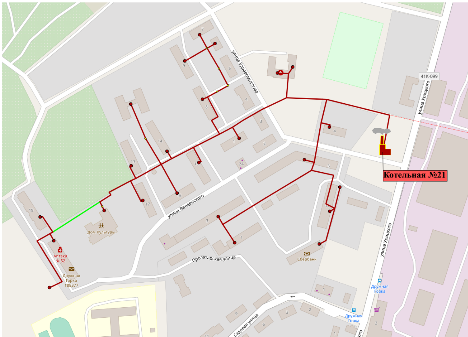
Рисунок 73. Реконструкция участков тепловых сетей котельной №21 пос. Дружная Горка с увеличением диаметра трубопроводов (контур ГВС)
