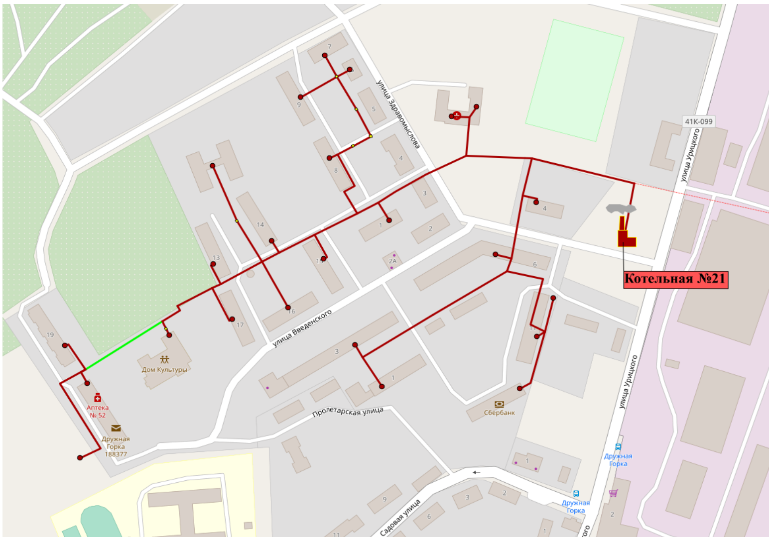
Рисунок 8. Реконструкция участков тепловых сетей котельной №21 пос. Дружная Горка с увеличением диаметра трубопроводов (контур ГВС)
