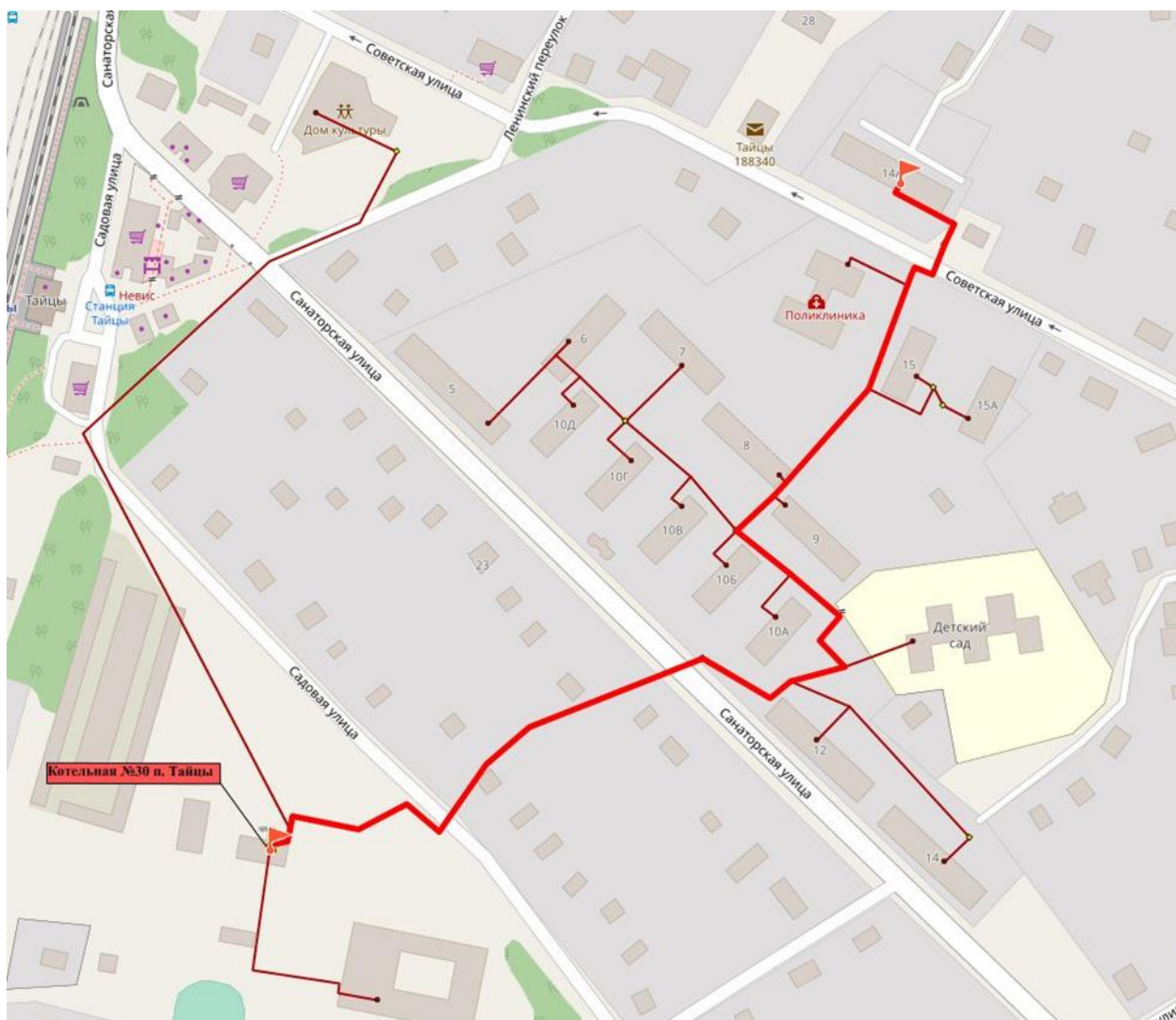
Рисунок 68 Путь построения пьезометрического графика от котельной №30 до ул. Советская, 14А (контур ГВС)
