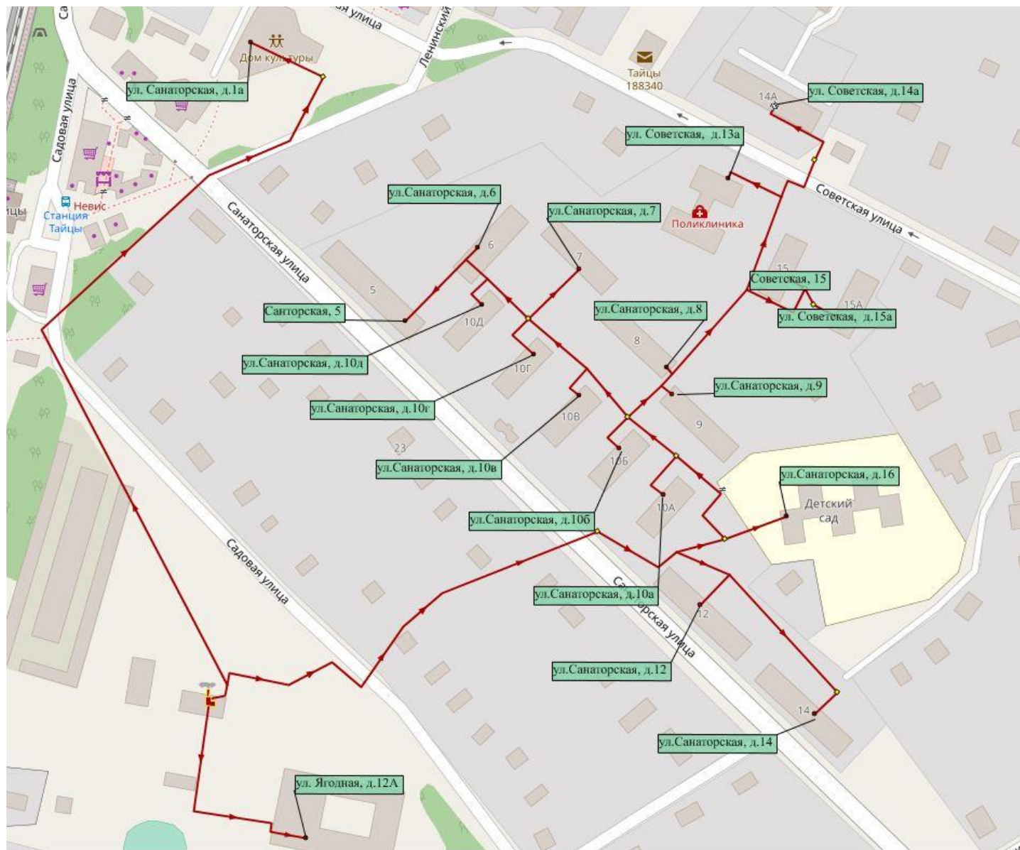
Рисунок 7 Схема тепловых сетей котельной №30 пос. Тайцы (контур ГВС)
