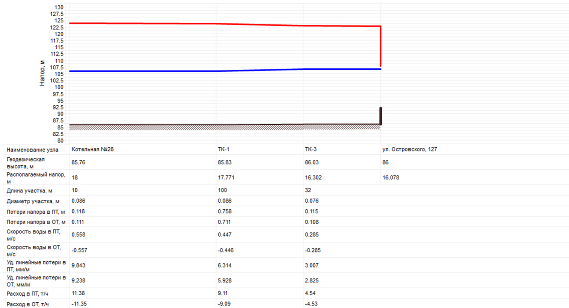
Рисунок 65 Пьезометрический график от котельной №28 до ул. Островского 127
