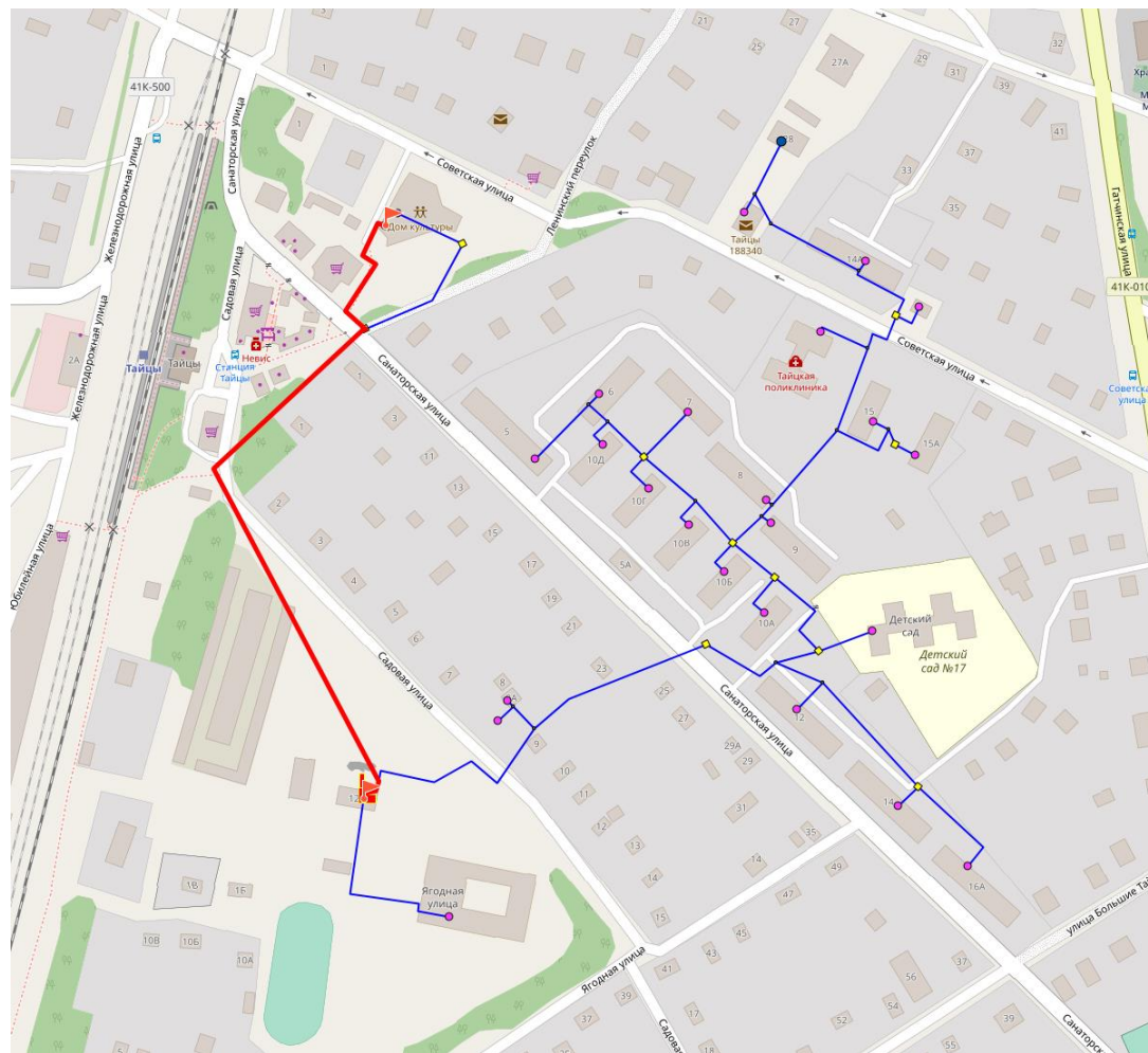
Рисунок 70 Путь построения пьезометрического графика до перспективного потребителя
