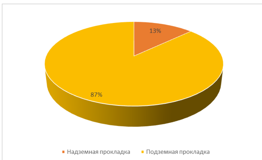
Рисунок 10 Распределение сетей ГВС котельной №30 по типу прокладки
