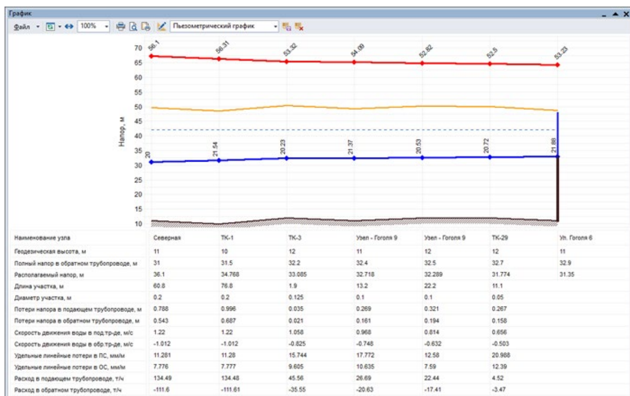
Рисунок 3.26. Пример пьезометрического графика
