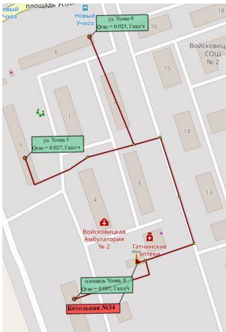
Рисунок 10. Схема тепловых сетей котельной №34 пос. Новый Учхоз (контур ГВС)
