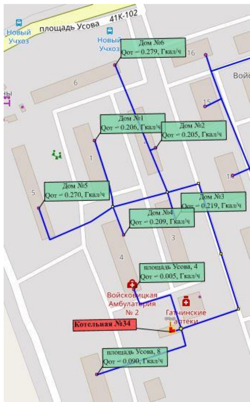
Рисунок 9. Схема тепловых сетей котельной №34 пос. Новый Учхоз (контур отопления)
