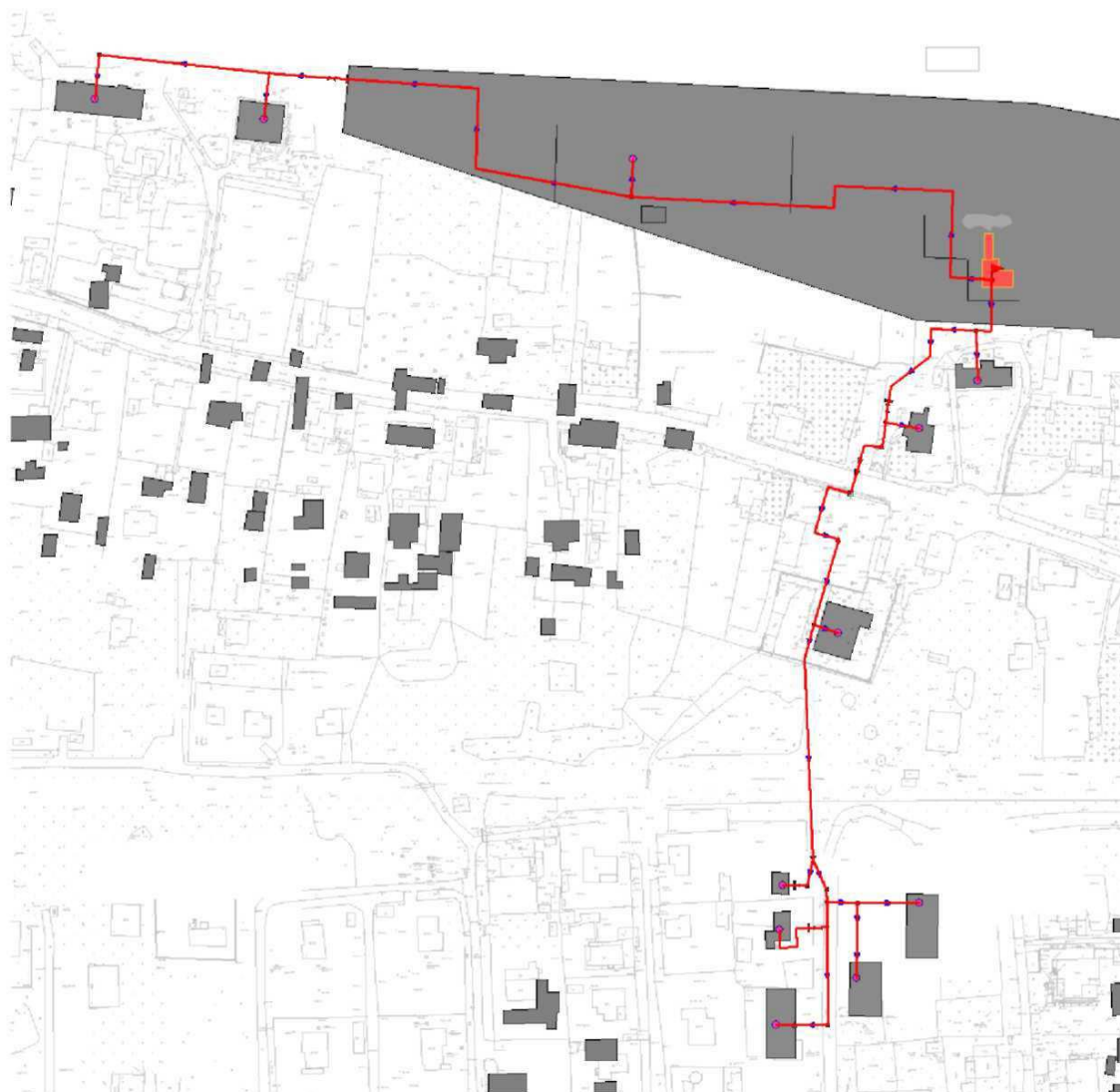
Рисунок 1.14 Расчетная схема зоны теплоснабжения потребителей от котельной «ЭЛТЕЗА»
