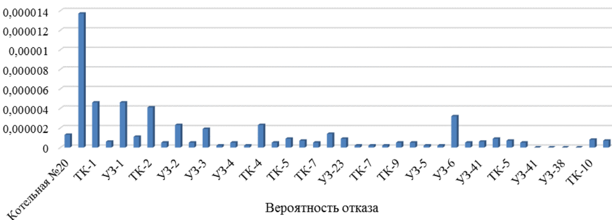
Рисунок 11.2.1. Вероятности состояния ТС, соответствующие отказам ее элементов, котельная №20
