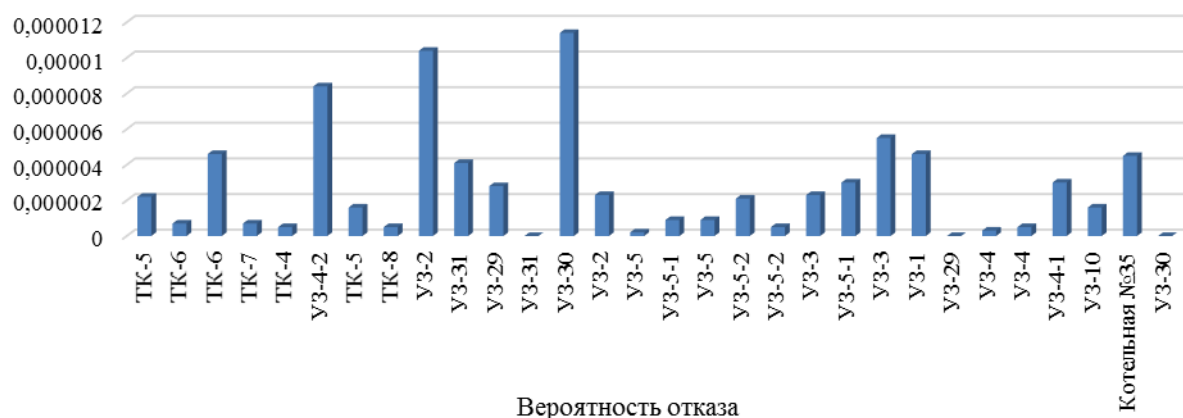
Рисунок 11.2.2. Вероятности состояния ТС, соответствующие отказам ее элементов, котельная №35
