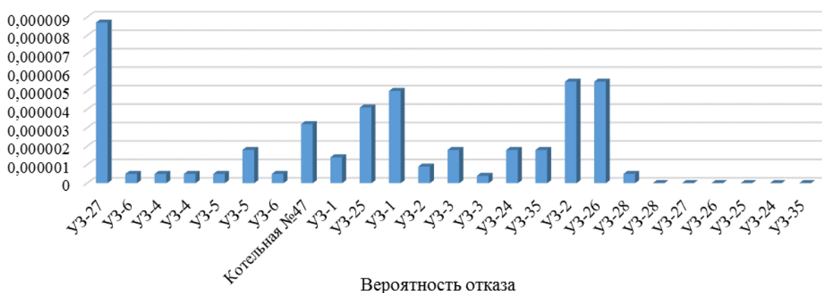
Рисунок 11.2.4. Вероятности состояния ТС, соответствующие отказам ее элементов, котельная №47
