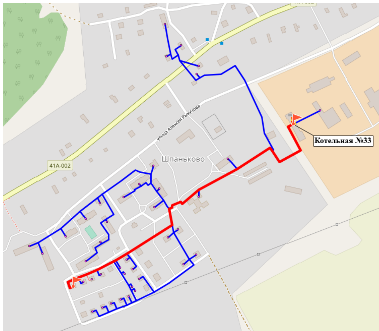
Рисунок 3.10.3. Путь ПГ от котельной №33 до Рыкунова 34 (сущ. пол.)
