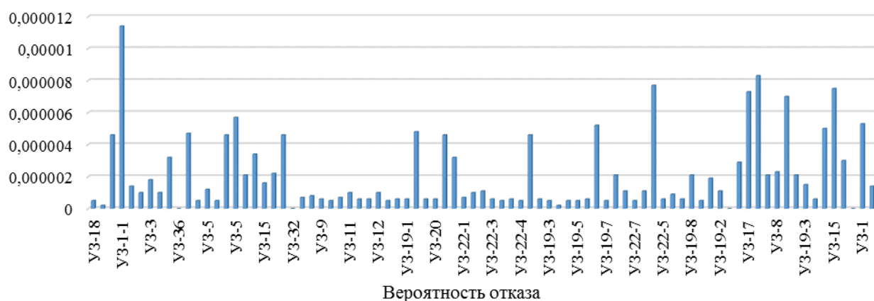
Рисунок 11.2.3. Вероятности состояния ТС, соответствующие отказам ее элементов, котельная №33
