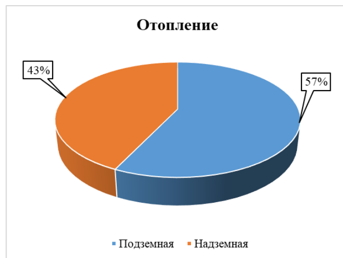
Рисунок 10. Распределение сетей отопления котельной №52 по типу прокладки
