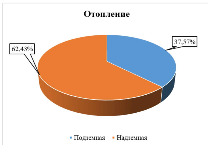
Рисунок 8. Распределение сетей отопления котельной №36 по типу прокладки
