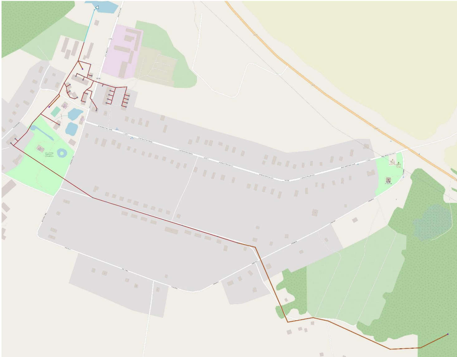
Рисунок 2.4.1. Трассировка сетей водоотведения, перспективное положение в д. Жабино
