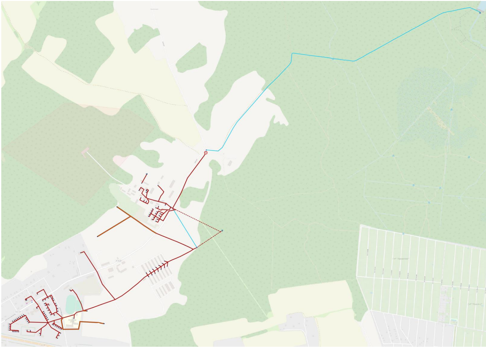
Рисунок 2.4.2. Трассировка сетей водоотведения, перспективное положение в д. Сяськелево и Тойворово
