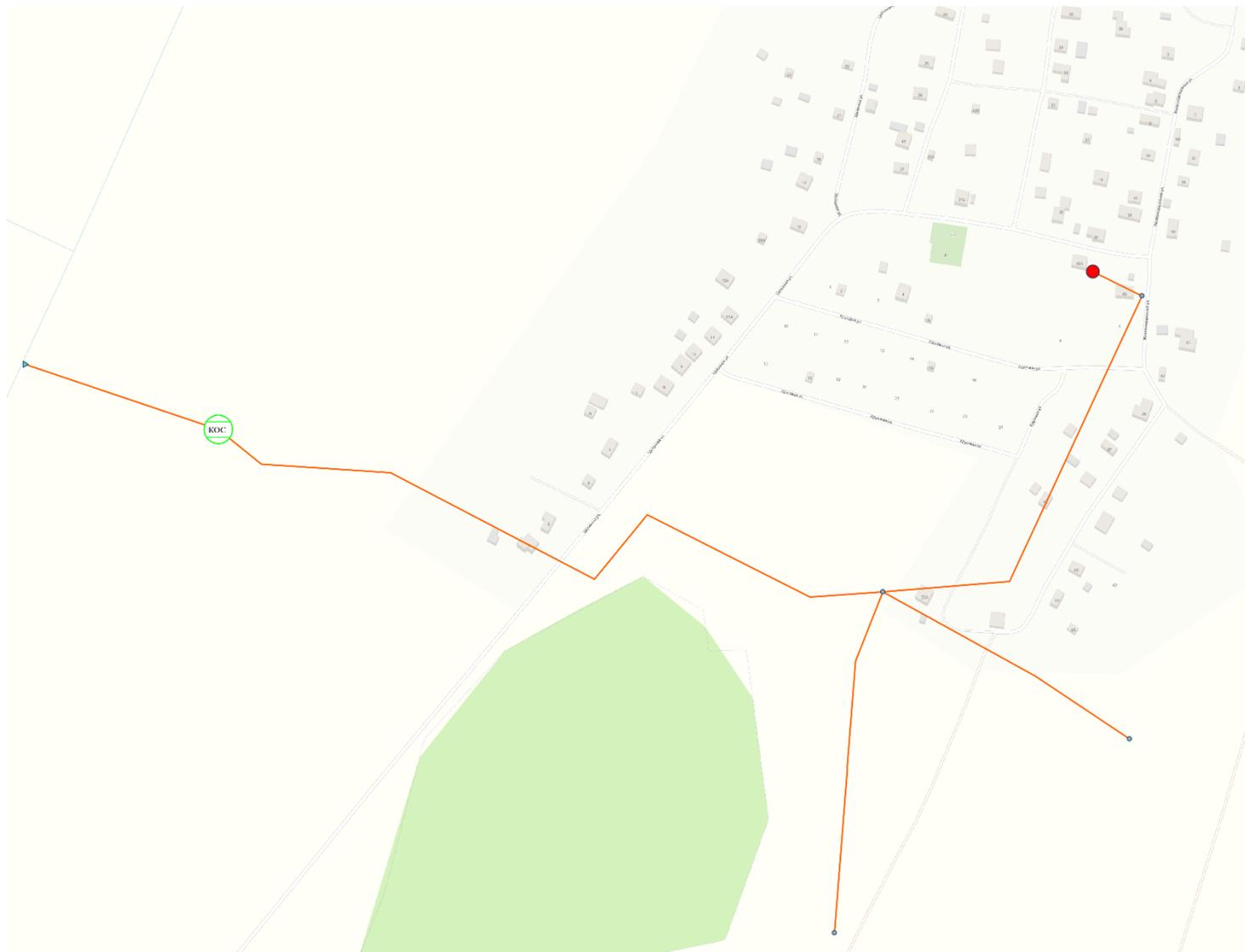
**Рисунок 23. Трассировка сетей водоотведения, перспективное положение в д. Сабры**
