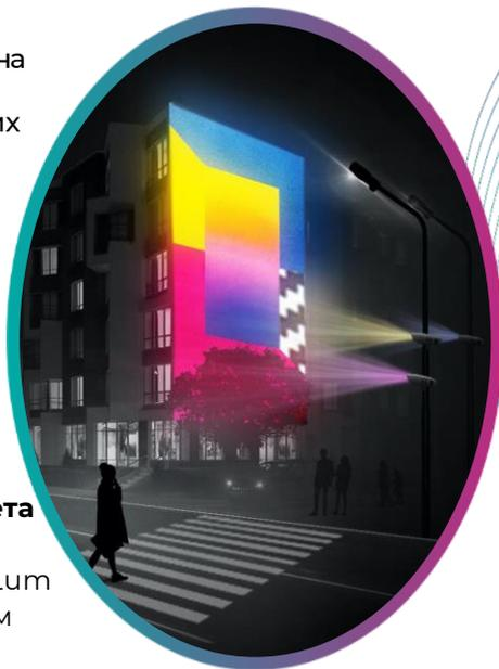
**2.** Массив проекторов формирует единую бесшовную проекционную зону, с однородной освещенностью. Где каждый проектор засвечивает свою область.
